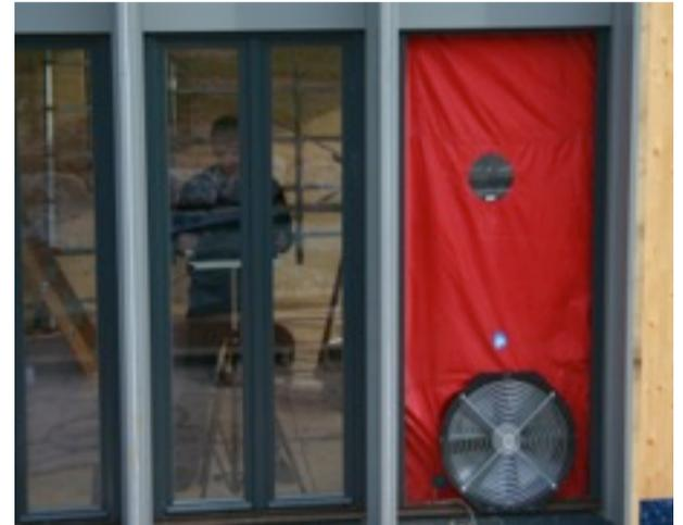
test d'étanchéité à l'air par «blower door» dans la maison prototype homelib (Drôme)
